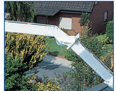
Zwei integrierte Hydraulik-Zylinder im Klappspitzengelenk
