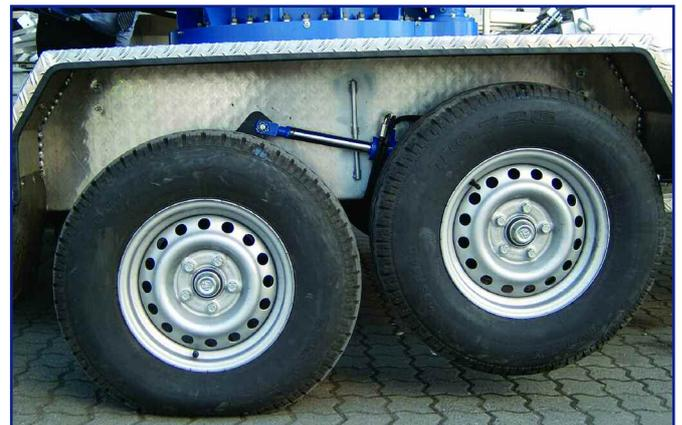
Liftachse für punktgenaues Rangieren
